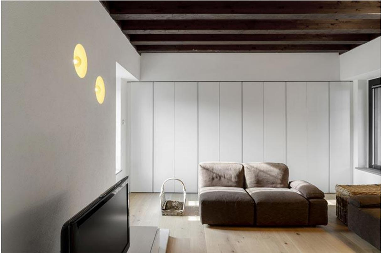
Eine weitere Einbaulösung mit starker ästhetischer Wirkung ist Lentil, ein kleines Oval, das die Aufmerksamkeit auf sich zieht: eine Gehwegleuchte mit einer Wandwaschparabel, die das Licht verwischt, einer konvexen Emissionsöffnung und einem um 45° geneigten Lichtkegel, der zu einem kleinen Protagonisten kleiner Räume, wie der Treppe der Villa, wird.
