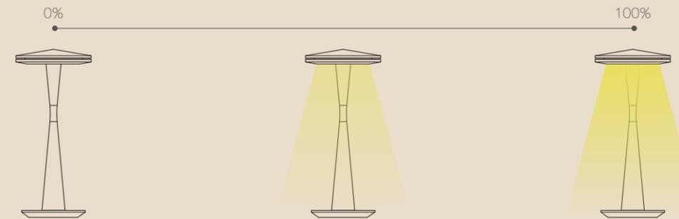
OR è dotata di sorgente luminosa LED, touch dimmer con regolazione della potenza. La durata della batteria è di 8 ore (con luce alla massima intensità).
