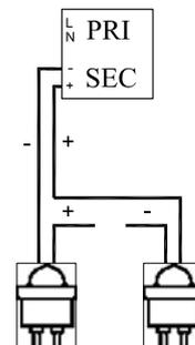
Il seguente prodotto LED è stato testato e risulta perfettamente funzionante. Porre la massima attenzione alla polarità (+, cavo rosso/-, cavo nero) di connessione per non provocare danni. **Connessione LED in serie.** In fase di sostituzione dei LED scollegare sempre l'alimentatore dalla rete elettrica.
